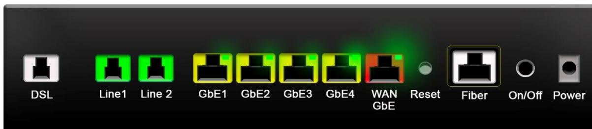
**DSL:** Porta per il collegamento del doppino DSL. Il cavo va da questa porta alla presa del telefono (doppino ADS/VDSL).
